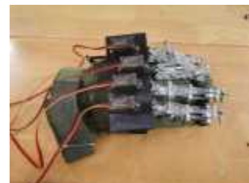
Doctor hand 1.0 提出了第一代康复机械手模型并做了样机
